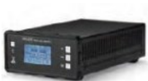
ХРА125В: Усилитель мощности Xiegu 100 Вт, включая автоматический антенный тюнер. (ОЧЕНЬ ДОВОЛЕН)
